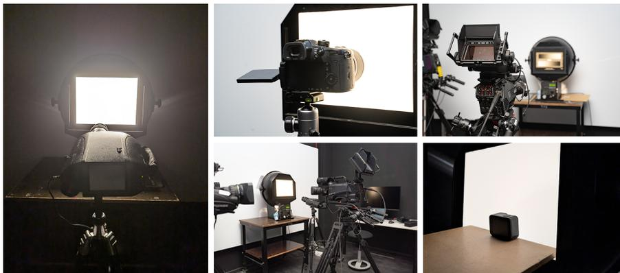
Abbildung 5.1.: Der Messaufbau im Dunkelraum der Lang AG
