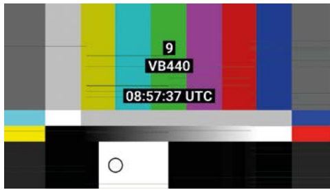
Abb. 4: Artefakte im Bildsignal bei einer Netzüberlastung
